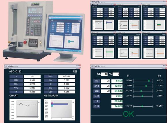
1・2・3段荷重・ばね定数・自由長・初張力・密着高さ等、全ての測定データ、Xbar-R管理図やヒストグラムなどのグラフ表示やロットの最大値・最小値・平均値・範囲・標準偏差・Cp・Cpk等をリアルタイムに表示します。品番のバーコード入力にも対応し一度で試験条件が整いタイムリーな品質管理を行うことができます。
