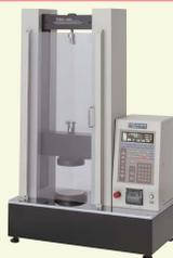
インターロック付きで、試験中のばね飛散に防護としてご使用いただけます。本体注文時にご指定ください。
