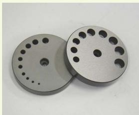
座屈する細長いばねの試験に、レボルブ圧縮板をお勧めします。穴位置は回転と固定ができ、試験中シャフトは上圧縮板の孔を通り、簡単に試験が行えます。
