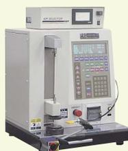
全数選別時の選別ミスを防ぐエア選別システムです。合格、+不合格、-不合格をエアで吹き分けることで、選別中に不良品を良品に混入してしまう選別ミスを防ぎます。
